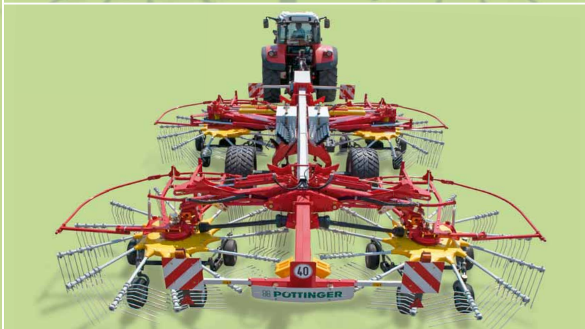
Přestavení předního rotoru při objíždění stranové překážky (sloup)
