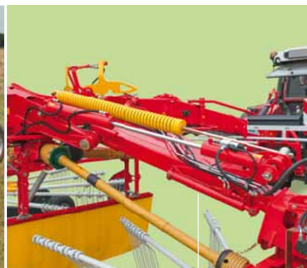
Hydraulicky přestavitelný pracovní záběr i šířka řádku
